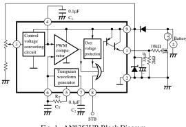
Fig. 1 AN8353UB Block Diagram
