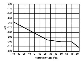
FIGURE 7. V<sub>OT</sub> vs TEMPERATURE
