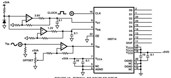
FIGURE 10. TYPICAL DC COUPLED INPUT
