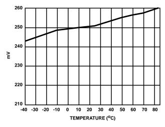
FIGURE 8.  $V_{\mbox{OB}}$  vs TEMPERATURE
