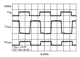
FIGURE 13. LOOPBACK TEST AT 120kbps
