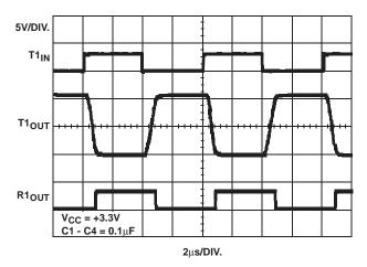
FIGURE 14. LOOPBACK TEST AT 250kbps
