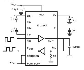
FIGURE 12. TRANSMITTER LOOPBACK TEST CIRCUIT
