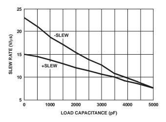
FIGURE 17. SLEW RATE vs LOAD CAPACITANCE
