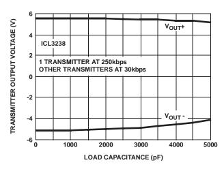
FIGURE 16. TRANSMITTER OUTPUT VOLTAGE vs LOAD CAPACITANCE
