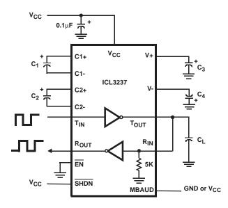
FIGURE 5. TRANSMITTER LOOPBACK TEST CIRCUIT
