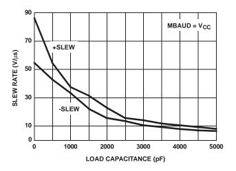
FIGURE 11. HIGH SPEED SLEW RATE vs LOAD CAPACITANCE
