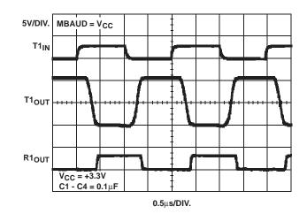
FIGURE 7. LOOPBACK TEST AT 1Mbps (CL = 250pF)
