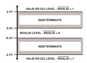
FIGURE 6. DEFINITION OF VALID RS-232 RECEIVER LEVELS
