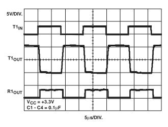
FIGURE 12. LOOPBACK TEST AT 120kbps
