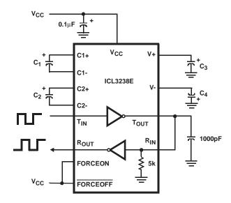
FIGURE 11. TRANSMITTER LOOPBACK TEST CIRCUIT
