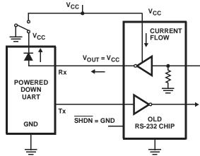
FIGURE 2. POWER DRAIN THROUGH POWERED DOWN
