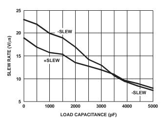
FIGURE 15. SLEW RATE vs LOAD CAPACITANCE
