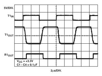
FIGURE 13. LOOPBACK TEST AT 250kbps
