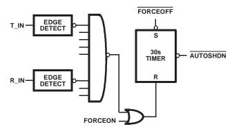
FIGURE 7. ENHANCED AUTOMATIC POWERDOWN LOGIC
