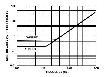
FIGURE 14. NONLINEARITY vs FREQUENCY
