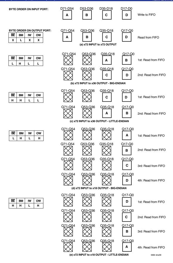
Figure 5. Bus-Matching Byte Arrangement
