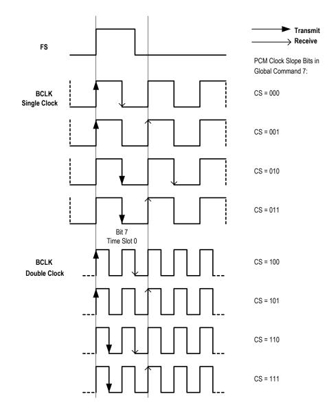
Figure 3 Sampling Edge Select Waveform
