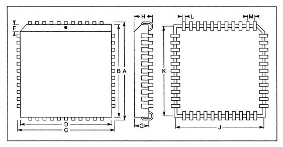
Figure 5.5 44 pin PLCC J-bend package dimensions
