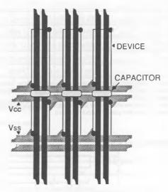
V<sub>CC</sub>, V<sub>SS</sub> GRID SHOWING DECOUPLING CAPACITORS
