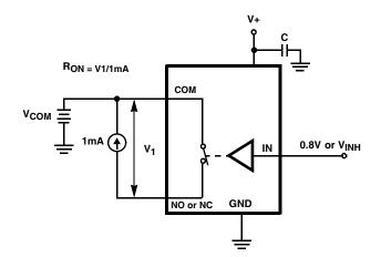
FIGURE 4. RON TEST CIRCUIT
