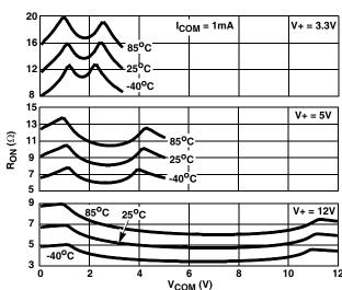
FIGURE 8. ON RESISTANCE vs SWITCH VOLTAGE
