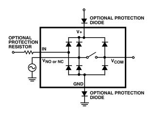
FIGURE 6. OVERVOLTAGE PROTECTION
