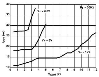
FIGURE 14. TURN - OFF TIME vs SWITCH VOLTAGE
