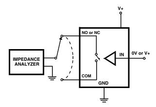
FIGURE 5. CAPACITANCE TEST CIRCUIT
