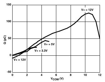
FIGURE 9. CHARGE INJECTION vs SWITCH VOLTAGE
