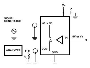
FIGURE 3. OFF ISOLATION TEST CIRCUIT
