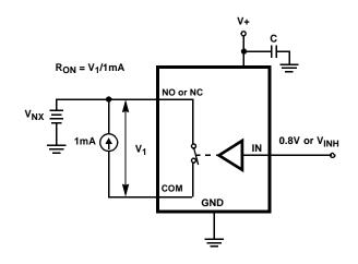
FIGURE 5. RON TEST CIRCUIT
