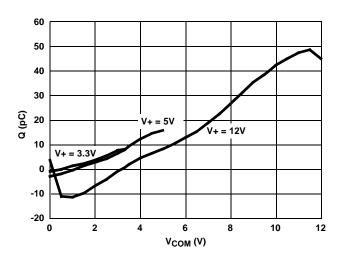
FIGURE 12. CHARGE INJECTION vs SWITCH VOLTAGE
