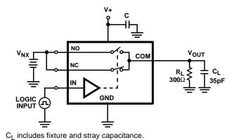
FIGURE 3D. TEST CIRCUIT (ISL5123 ONLY)
