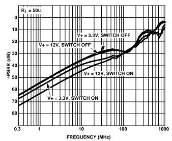
FIGURE 18. ±PSRR vs FREQUENCY
