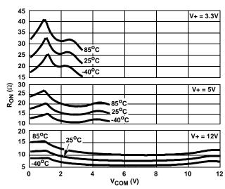
FIGURE 10. ON RESISTANCE vs SWITCH VOLTAGE
