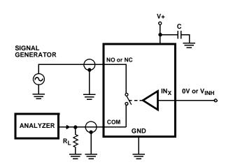
FIGURE 4. OFF ISOLATION TEST CIRCUIT
