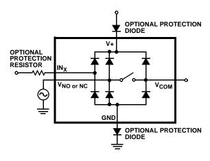
FIGURE 8. OVERVOLTAGE PROTECTION
