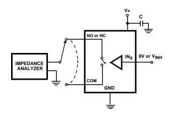
FIGURE 7. CAPACITANCE TEST CIRCUIT
