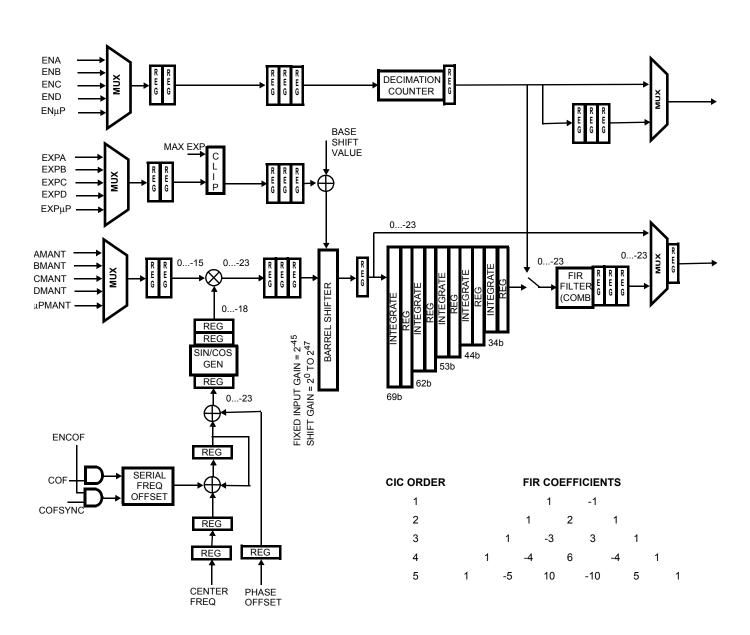
FIGURE 3. NCO, MIXER AND CIC BLOCK DIAGRAM
