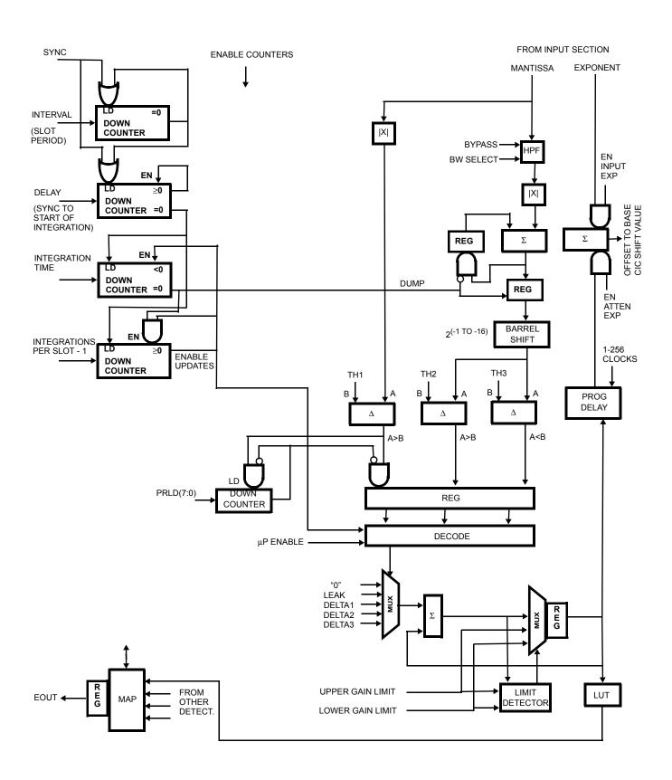
FIGURE 2. RANGE CONTROL BLOCK DIAGRAM
