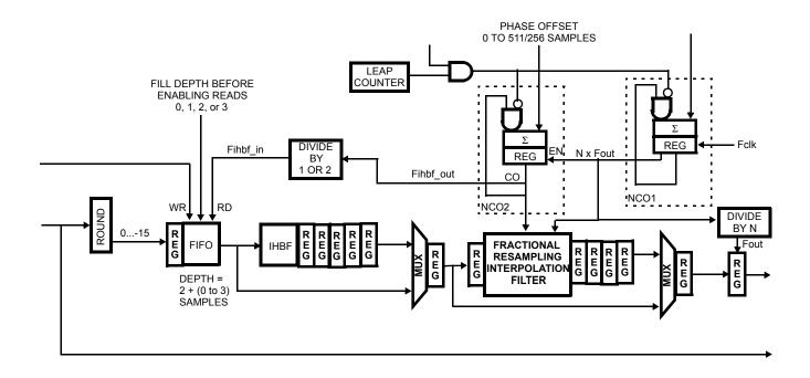
FIGURE 8. IHBF AND RESAMPLER BLOCK DIAGRAM
