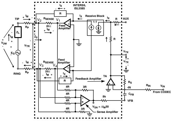
FIGURE 4. AC SIGNAL TRANSMISSION MODEL
