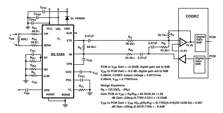
FIGURE 17. ISL5585 3.3V APPLICATION CIRCUIT
