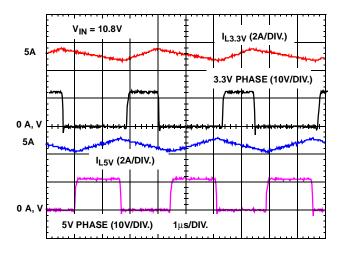
FIGURE 1. OUT OF PHASE OPERATION
