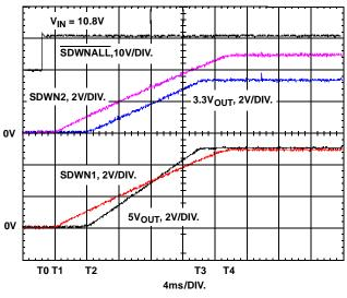
FIGURE 2. SOFT START ON 3.3V AND 5V OUTPUTS
