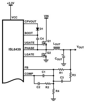
FIGURE 2. OUTPUT VOLTAGE SELECTION
