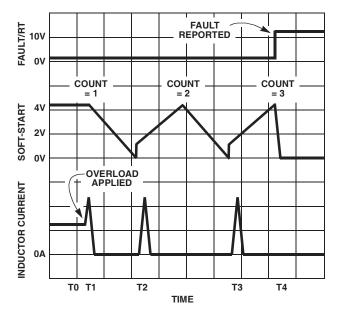
FIGURE 4. OVERCURRENT OPERATION
