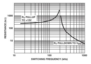
FIGURE 1. R<sub>T</sub> RESISTANCE vs FREQUENCY
