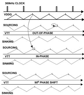
FIGURE 8. CHANNEL INTERFERENCE Vin=5V
