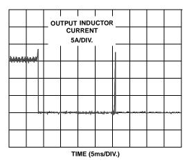
FIGURE 1. OVERCURRENT OPERATION
