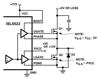
FIGURE 10. UPPER GATE DRIVE - DIRECT V<sub>CC</sub> DRIVE OPTION
