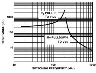
FIGURE 1. RT RESISTANCE vs FREQUENCY
