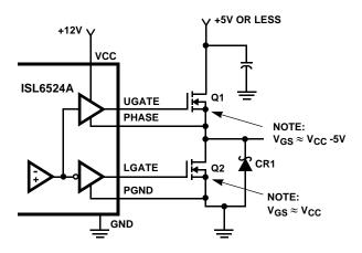
FIGURE 13. UPPER GATE DRIVE - DIRECT V<sub>CC</sub> DRIVE
