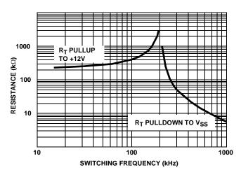
FIGURE 4. R<sub>T</sub> RESISTANCE vs FREQUENCY
