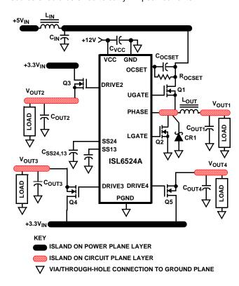
FIGURE 10. PRINTED CIRCUIT BOARD POWER PLANES AND ISLANDS
