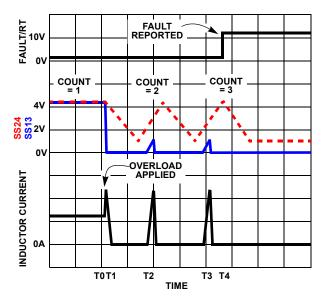
FIGURE 8. OVER-CURRENT OPERATION
