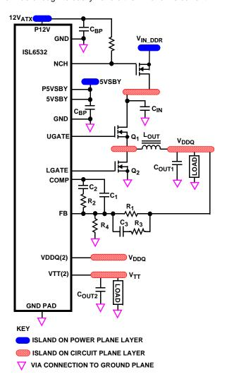
FIGURE 4. PRINTED CIRCUIT BOARD POWER PLANES
