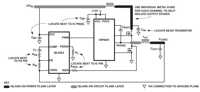
FIGURE 12. PRINTED CIRCUIT BOARD POWER PLANES AND ISLANDS
