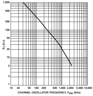
FIGURE 10. RESISTANCE RT vs FREQUENCY
