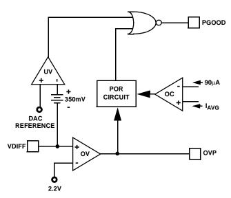
FIGURE 11. POWER GOOD AND PROTECTION CIRCUITRY
