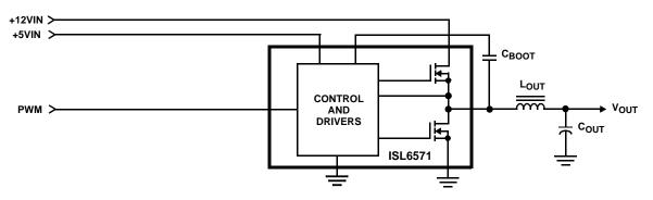
FIGURE 2. SIMPLIFIED POWER SYSTEM DIAGRAM
