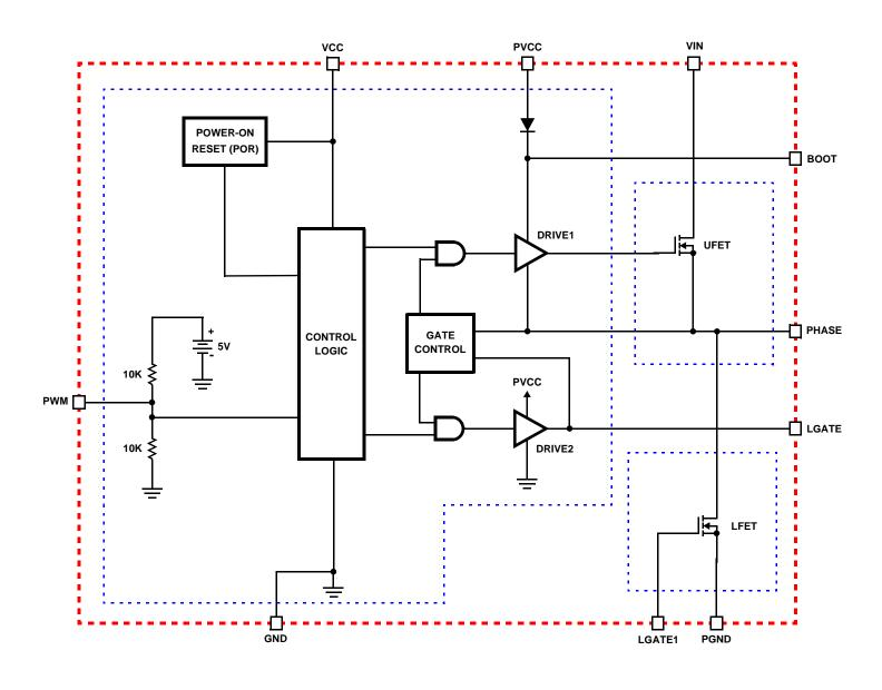
FIGURE 1. BLOCK DIAGRAM
