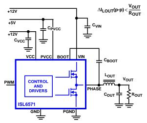
FIGURE 4. TYPICAL TEST CIRCUIT
