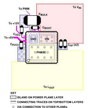
FIGURE 12. PRINTED CIRCUIT BOARD POWER PLANES AND ISLANDS
