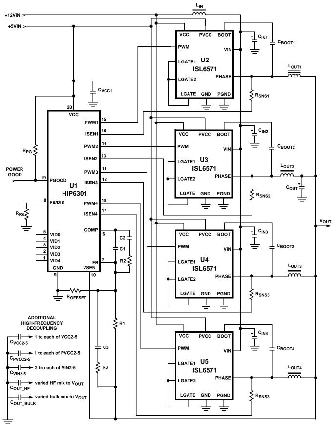
FIGURE 13. TYPICAL ISL6571 APPLICATION CIRCUIT
