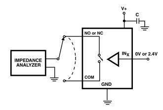
FIGURE 7. CAPACITANCE TEST CIRCUIT
