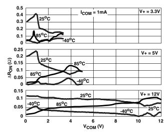
FIGURE 10. R<sub>ON</sub> MATCH vs SWITCH VOLTAGE
