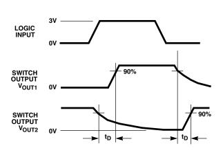
FIGURE 2. CHARGE INJECTION
