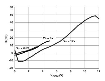
FIGURE 11. CHARGE INJECTION vs SWITCH VOLTAGE
