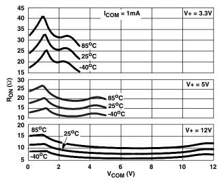
FIGURE 9. ON RESISTANCE vs SWITCH VOLTAGE
