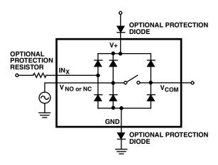
FIGURE 8. OVERVOLTAGE PROTECTION
