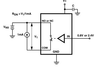
FIGURE 5. R<sub>ON</sub> TEST CIRCUIT
