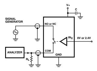
FIGURE 4. OFF ISOLATION TEST CIRCUIT
