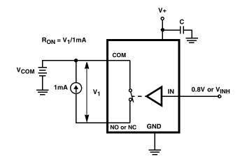
FIGURE 4. RON TEST CIRCUIT
