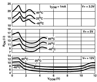
FIGURE 8. ON RESISTANCE vs SWITCH VOLTAGE
