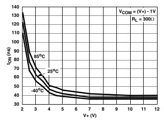
FIGURE 11. TURN-ON TIME vs SUPPLY VOLTAGE
