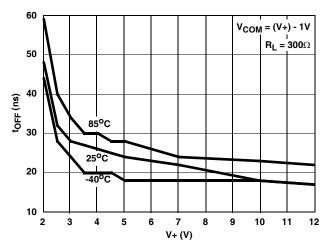
FIGURE 12. TURN-OFF TIME vs SUPPLY VOLTAGE
