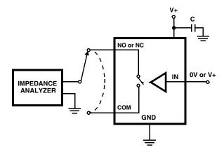
FIGURE 5. CAPACITANCE TEST CIRCUIT
