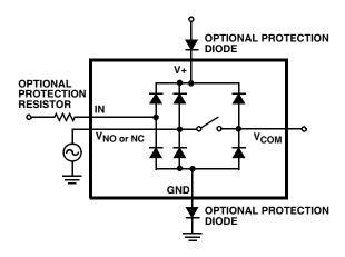
FIGURE 6. OVERVOLTAGE PROTECTION
