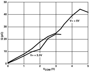
FIGURE 9. CHARGE INJECTION vs SWITCH VOLTAGE
