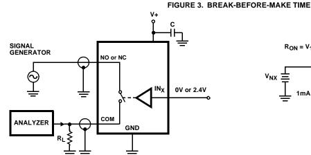
FIGURE 4. OFF ISOLATION TEST CIRCUIT
