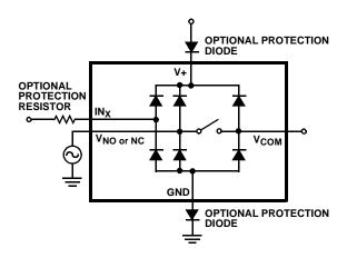
FIGURE 8. OVERVOLTAGE PROTECTION
