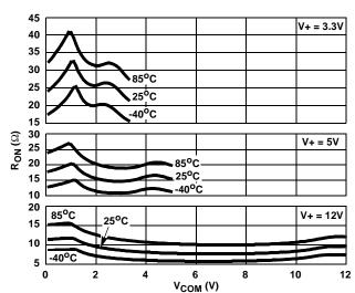
FIGURE 10. ON RESISTANCE vs SWITCH VOLTAGE
