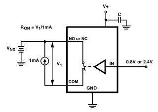
FIGURE 5. R<sub>ON</sub> TEST CIRCUIT
