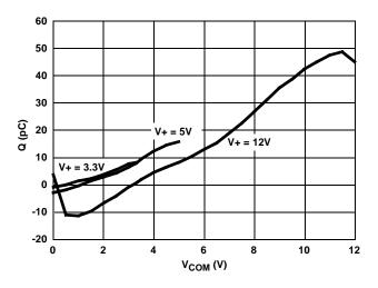
FIGURE 12. CHARGE INJECTION vs SWITCH VOLTAGE
