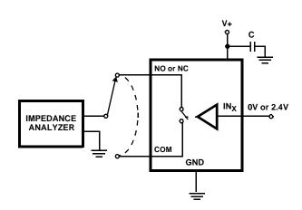
FIGURE 7. CAPACITANCE TEST CIRCUIT
