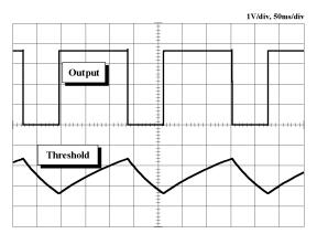
$R_A=1k\Omega$ ,  $R_B=1k\Omega$ ,  $R_L=1kW$ , C1=1uF, Vcc=5V
