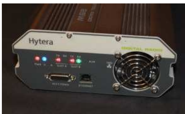
Fot. 1.3. Przemiennik „Hytery” RD625. Do wyjścia w eter potrzebny jest diplexer
