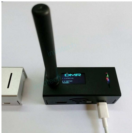
Fot. 5.56. MMDVM korzysta z dostępu do sieci WiFi w standardach 802.11b/g/n
