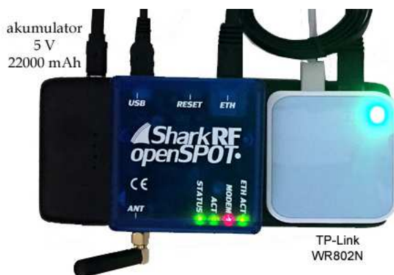
Fot. 5.55. Podręczny mikroprzeziennik dla cyfrowego głosu z zasilaniem akumulatorowym i przeziennikiem WiFi zapewniającym połączenie ethernetowe
