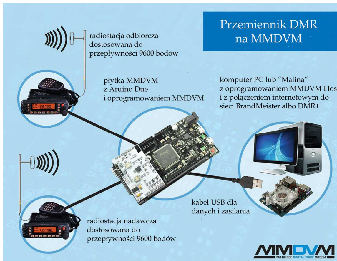
Fot. 1.4. Orientacyjny schemat blokowy przemiennika DMR na MMDV z radiostacjami pracującymi jako nadajnik i odbiornik i z komputerem dostępnym do Internetu
